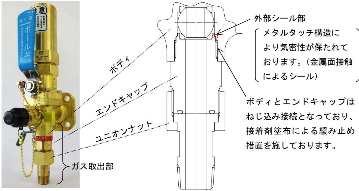
対象機種：堅型バルク貯槽 300、500、980kg と横型バルク貯槽 300kg のマルチバルブ
